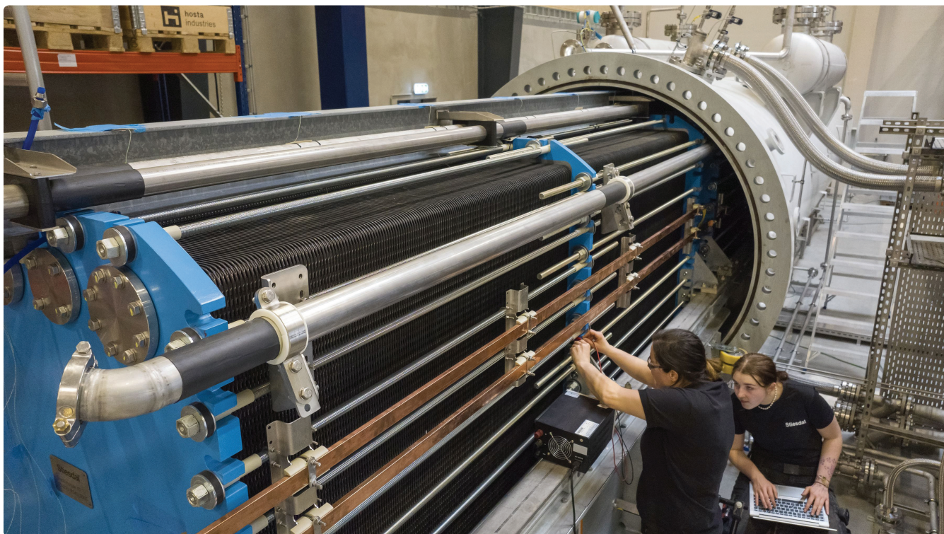
Figur 5 Montage af elektrodestak i tryktank.
