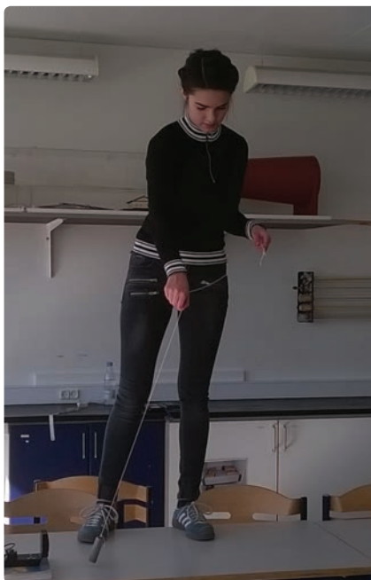
Figur 1 Helene (IB-elev på Birkerød Gymnasium) svinger med et konisk pendul foran en motionsensor.
