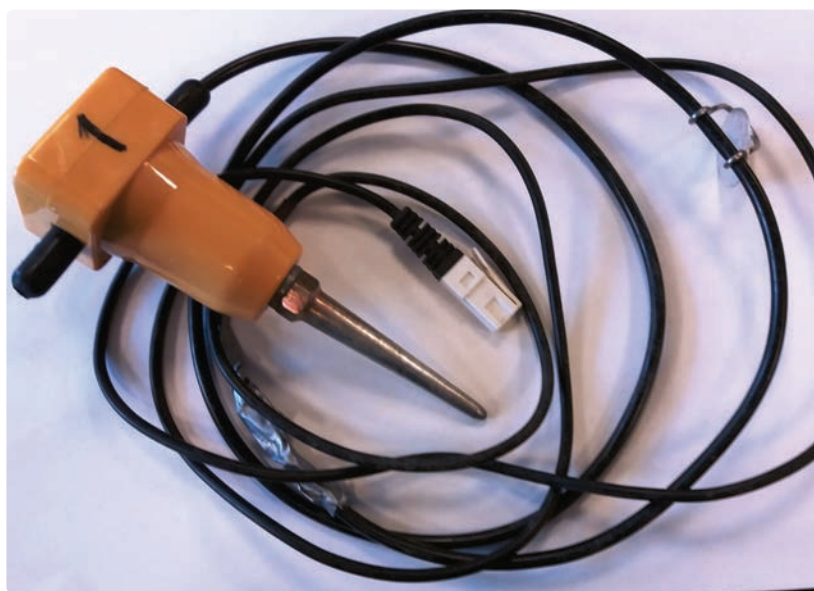
Figur 1 Geofon med jordspyd og hus med magnet og spole.
