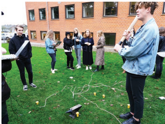
Figur 2 Geofonerne er placeret forskellig steder i forhold til den fælles geofon.
