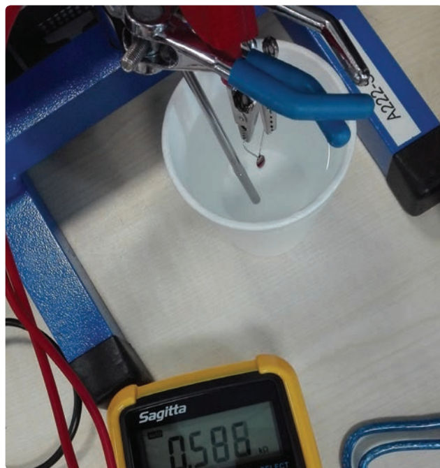
Figur 2. Forsøgsopstilling med NTC-termistor.
