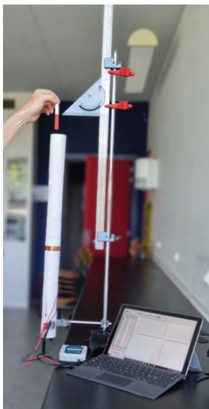
Figur 7 Forlængerrør hjælper magneten til at falde centralt og lodret, når faldhøjden er stor.
