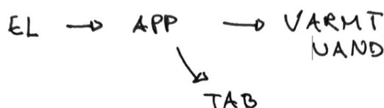
Figur 11.1 – Kun en andel af den tilføje elektriske energi genfindes som tilvækst i termisk i vandet. Der er netop et tab.
