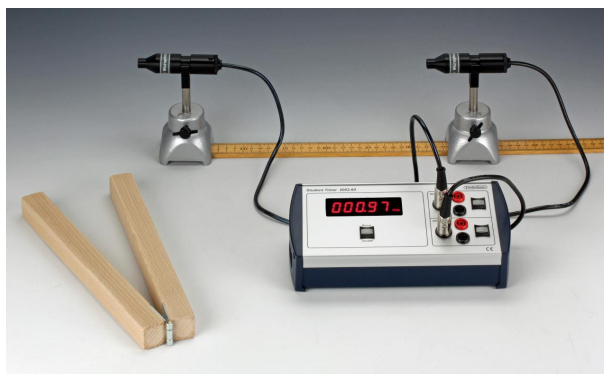
Figur 5.1 – Forsøget gennemføres med forskellige mikrofon afstande og tilhørende tidssmålinger.
