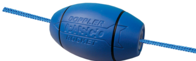
Figur 15.1 – Elektronikken har en frekvens på f_0 = 620\text{ Hz} , hvilket giver et dopplerskift på ca 20\text{ Hz} ved en hastighed på v = 10 \frac{\text{m}}{\text{s}} .
