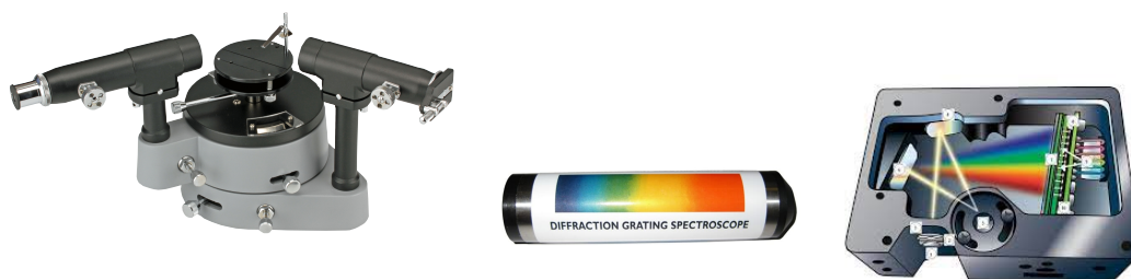
Figur 2.3 – For overhovedet at få empiri om disse samtidige bølgelængder, skal der anvendes udstyr. Startende fra venstre har vi et klassisk ur-magerinspireret analog spektrometer. Det er som at skulle spille på violin, de efterfølgende er moderne næsten optimeret til slutbrugere. De anvender alle gitterligningen.
