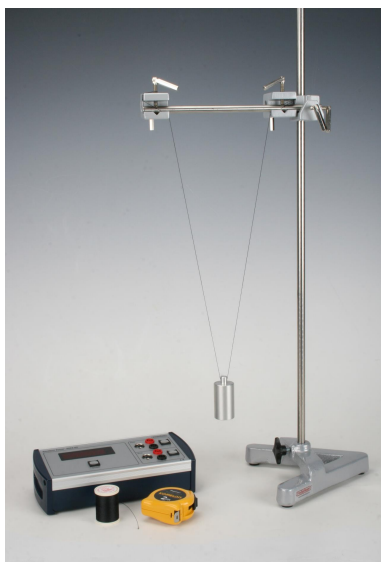
Figur 4.1 – Et lod bør ophænges i en vugge - netop for at fastholde lodet i samme svingningsplan. Lodlængden måles til massemidtunktet, og højdeforskellen angives som \Delta y .
