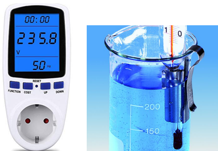
Figur 11.2 – En elmåler indsættes direkte i 230 volt udtaget og angiver enten effekten eller det samlede energiforbrug. Den termiske energi bestemmes ud fra energiligningen E = m \cdot c \cdot \Delta t
