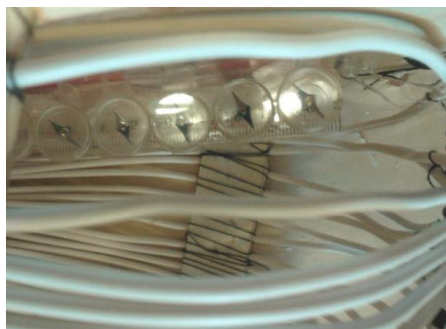
Fig 5 Billede af torus med små magneter uden og med strøm igennem vindingerne.
