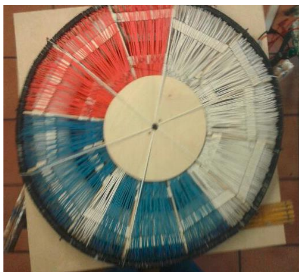
Fig 4 Billede af hjemmelavet pæreformet torus, der er ca 0,8 meter i diameter. Den sorte ring yderst er en torus med cirkelformede vindinger "blomsten" i fig 2. Fig 4 Th viser en tegnet figur med en pæreformet torus med 10 vindinger.
