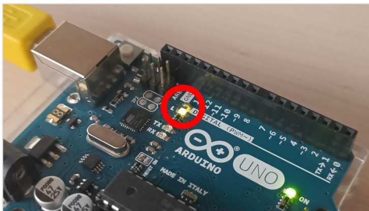
Den røde cirkel markerer den LED der er forbundet til microcontrollerens pin 13
