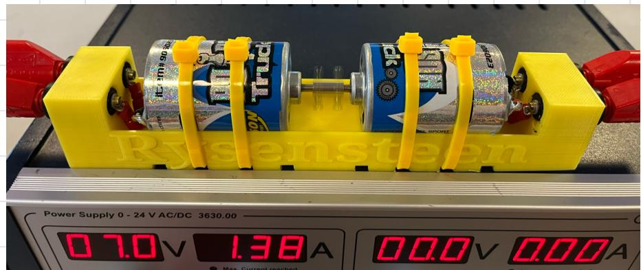
Den ene motor tilsluttes en spændingskilde og ved at mæle spændingen  $U$  og strømstyrken  $I$
